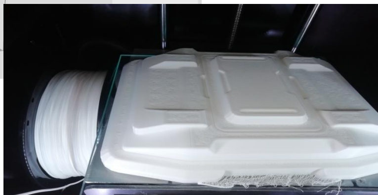
Рисунок 11. Создание элементов декора на 3D принтере.
