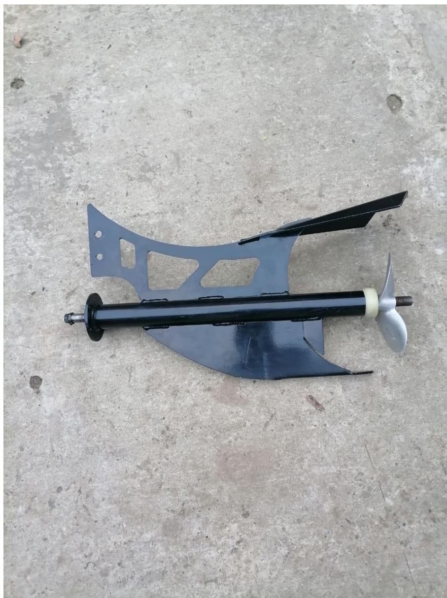
Рисунок 6. Усовершенствованная конструкция дейдвуда с отбойными плавниками (изменения внесены после испытаний на воде)
